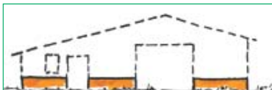
► Figure 20.1: le soubassement, ce qui représente l'assise du bâtiment.
